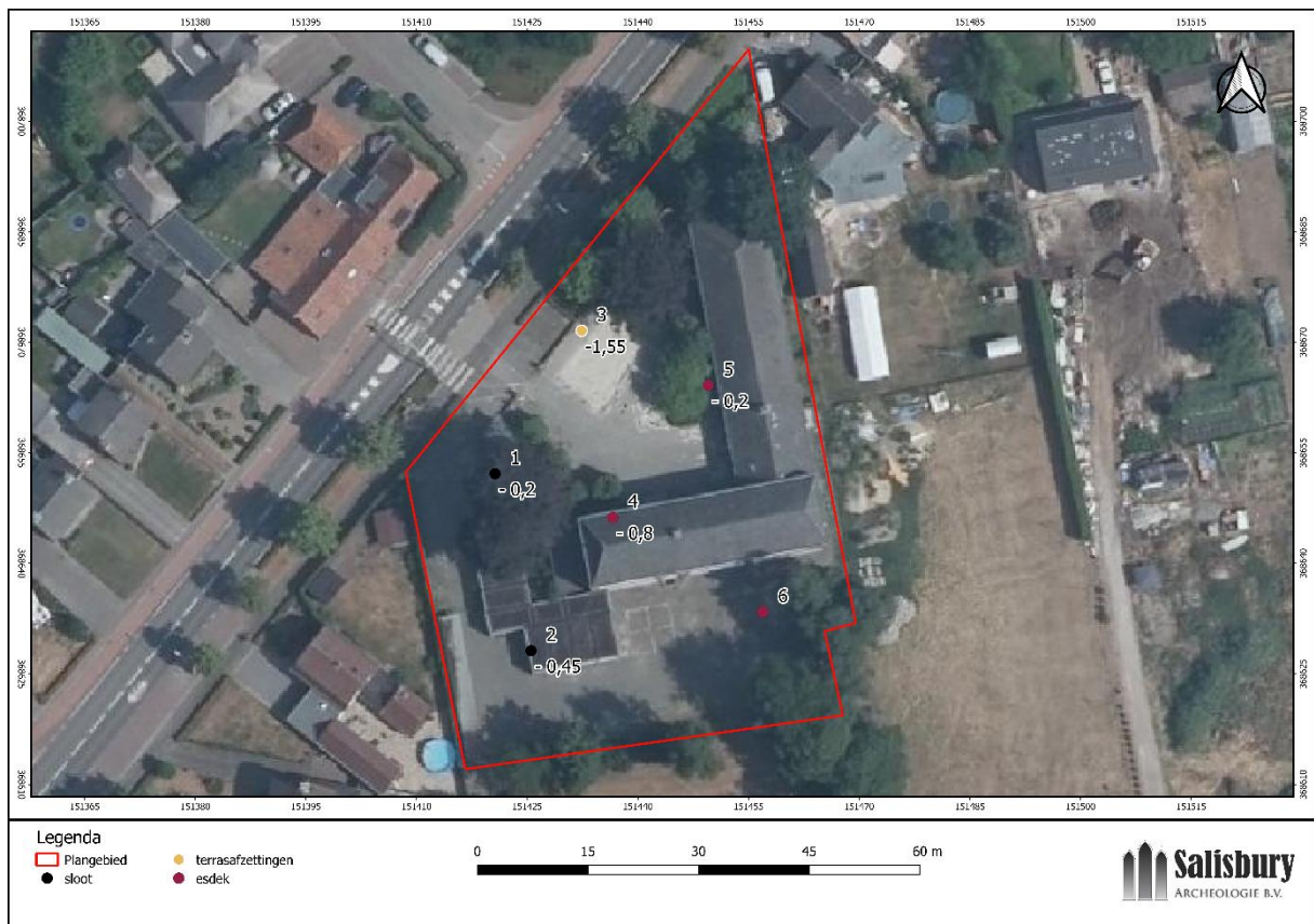
Afb. 4. Resultaten van het booronderzoek. Diepte van de verstoring is aangegeven in meters beneden maaiveld.
