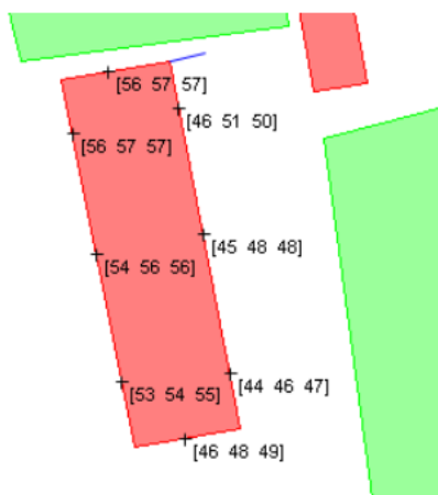
Figuur 3: geluidbelasting na scherm 1,8m hoog en 3m lang
