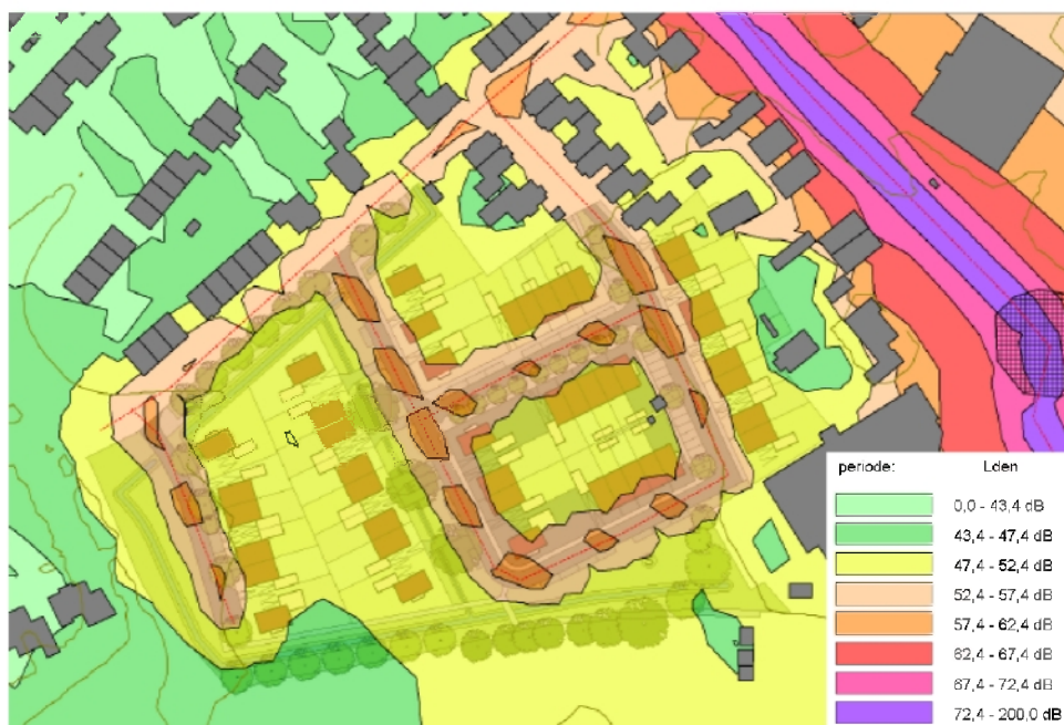
Afbeelding 8: Contouren geluidsbelasting wegverkeer op 1,5m hoogte (Lden)
