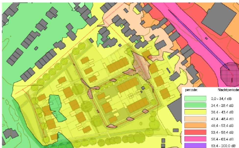
Afbeelding 9: Contouren geluidsbelasting wegverkeer op 5m hoogte (Lnight)
