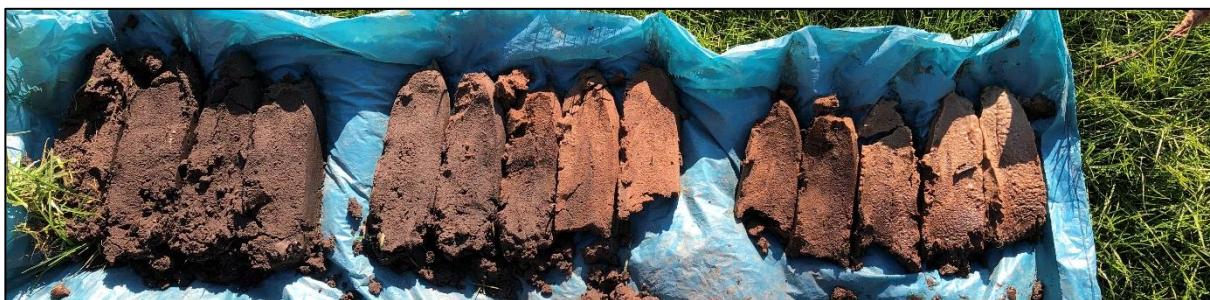
Boring 4: 0-150 cm -Mv. Diepst gelegen deel van het sediment zeer vochtig
