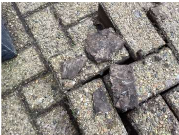
Figuur 3.1: Foto asbestverdachte plaatmaterialen uit proefgat B05
