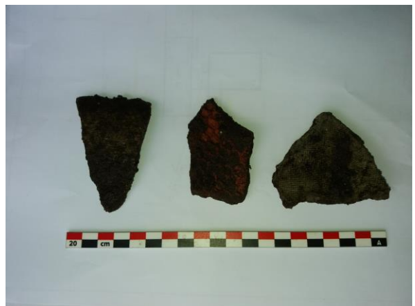
Foto 12: 3 soorten asbestverdacht materiaal
