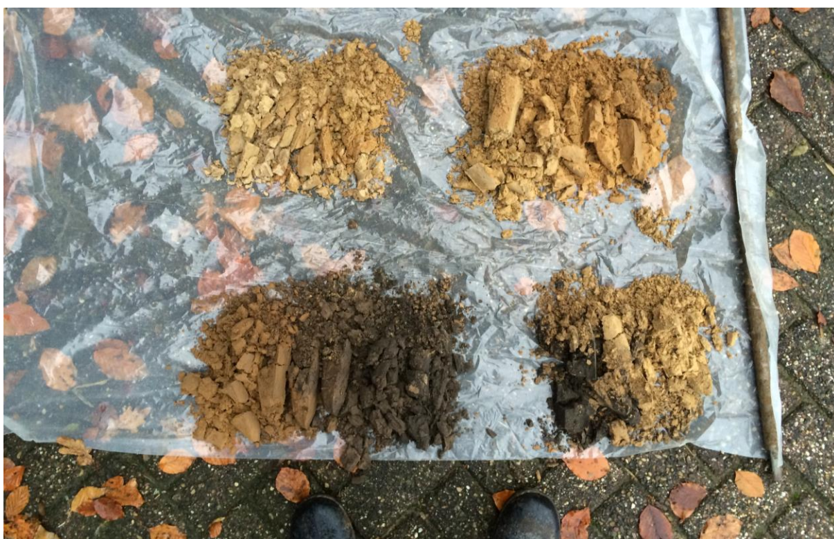
Opname van boring 5. Een duidelijk B/BC verloop in de top van het dekzand
