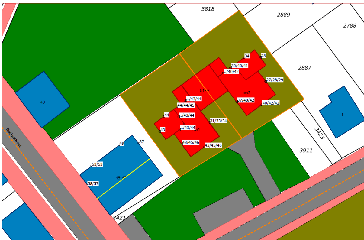
Figuur 4.1: Rekenresultaten vanwege de Stationstraat met aftrek van 5 dB.
