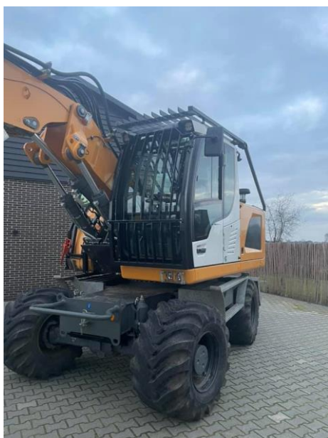
Reparatie en aanbrengen hekwerk kraan
