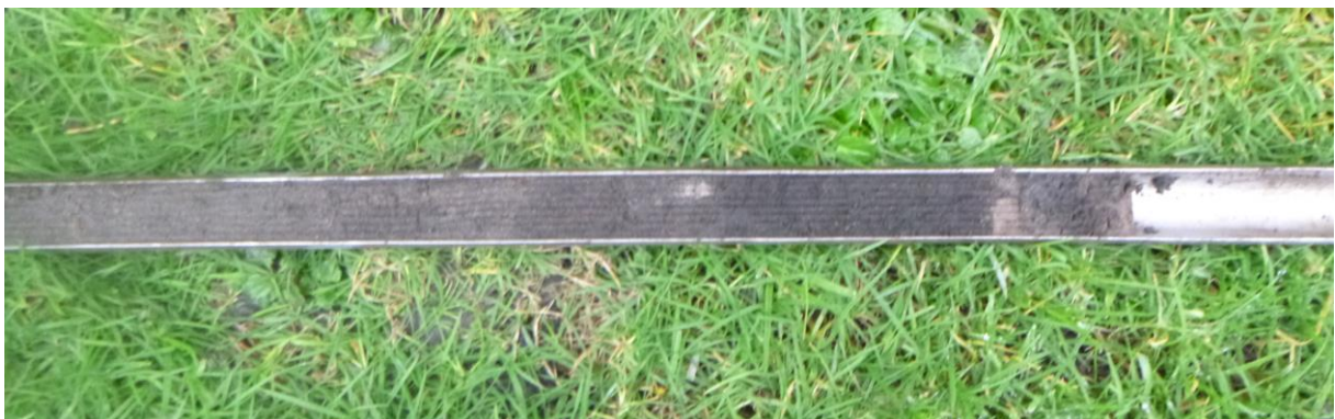
Figuur 23: Foto van boring 2 met geheel links het humusrijke zand van het akkerdek, links van het midden moerig zand, rechts van het midden matig veraard veen en geheel rechts de zwak venige en doorwortelde top van het dekzand.
