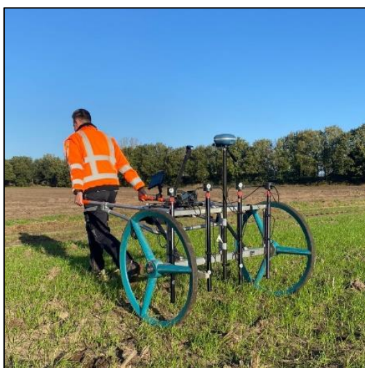
Afb.2 – Non-realtime oppervlakedetectie MS-4.
