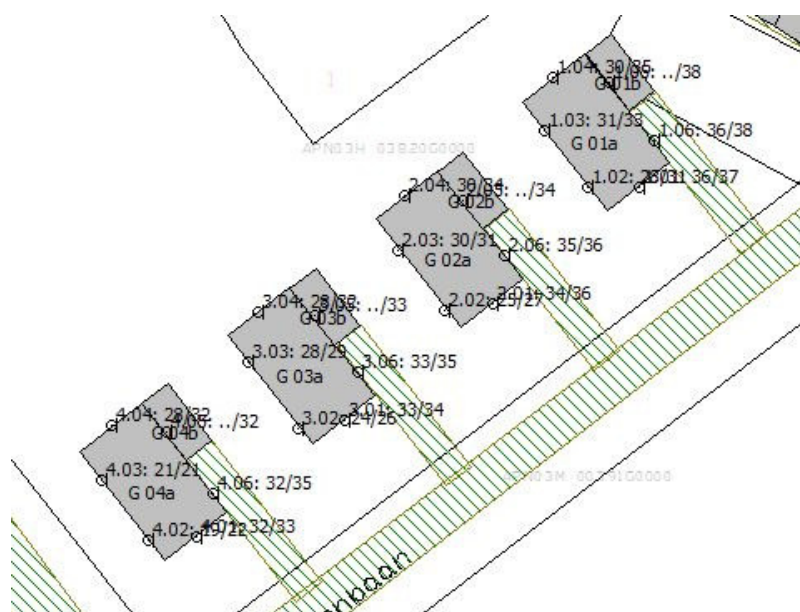
Figuur 5.1.1 Geluidbelasting vanwege de zone-plichtige weg St. Janstraat in dB L den (incl. correctie)
