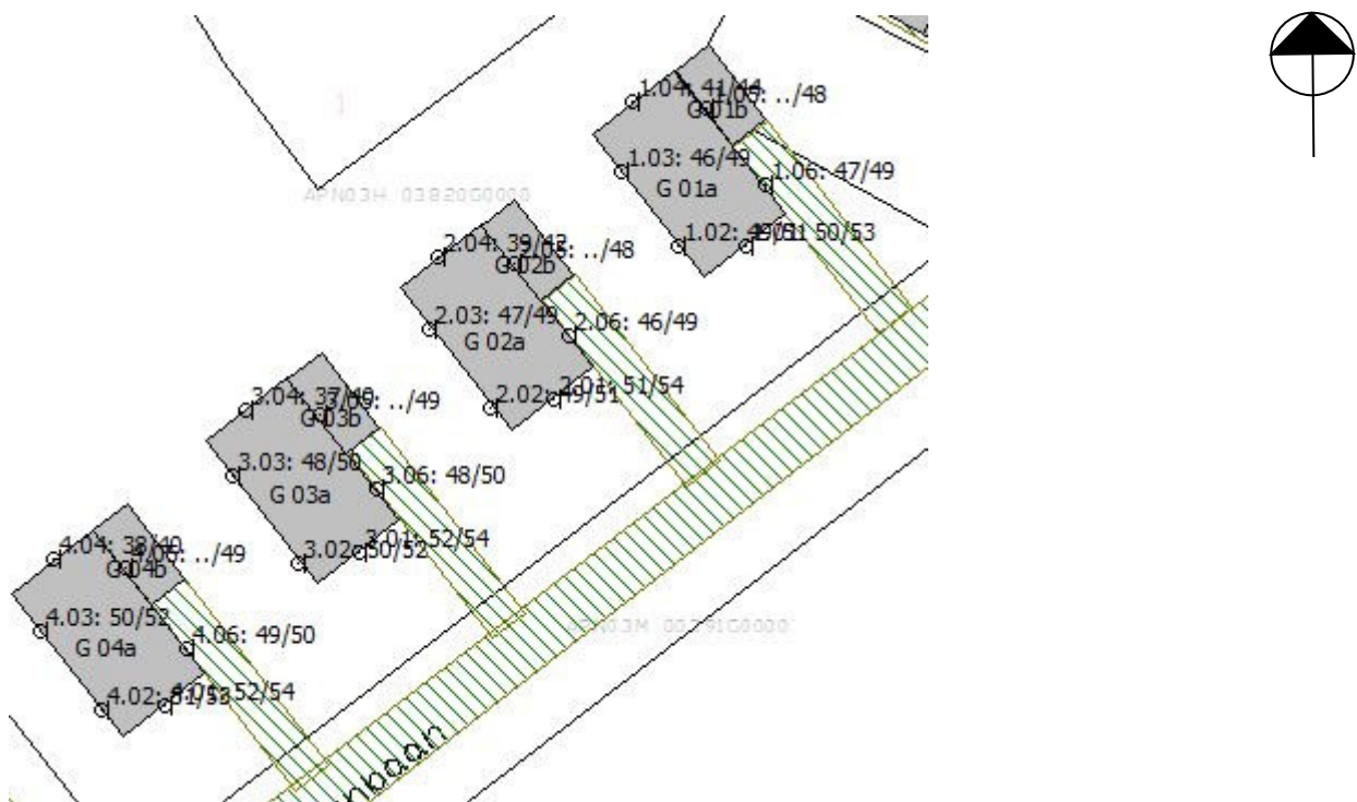
Figuur 5.2.1 Rekenresultaten cumulatie wegverkeerslawaai in dB Lden
