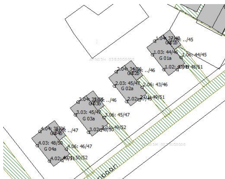
Figuur 5.1.2 Geluidbelasting vanwege de zone-plichtige weg N260 in dB L den (incl. correctie)
