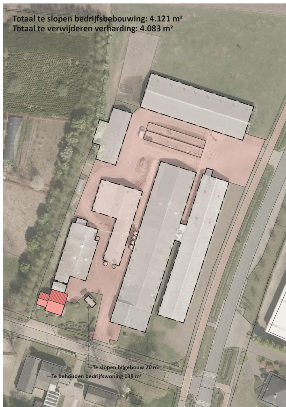
Te slopen bedrijfsbebouwing en te verwijderen verhardingen (inclusief mestbassins, sleufsilo's en een spuitplaats)
