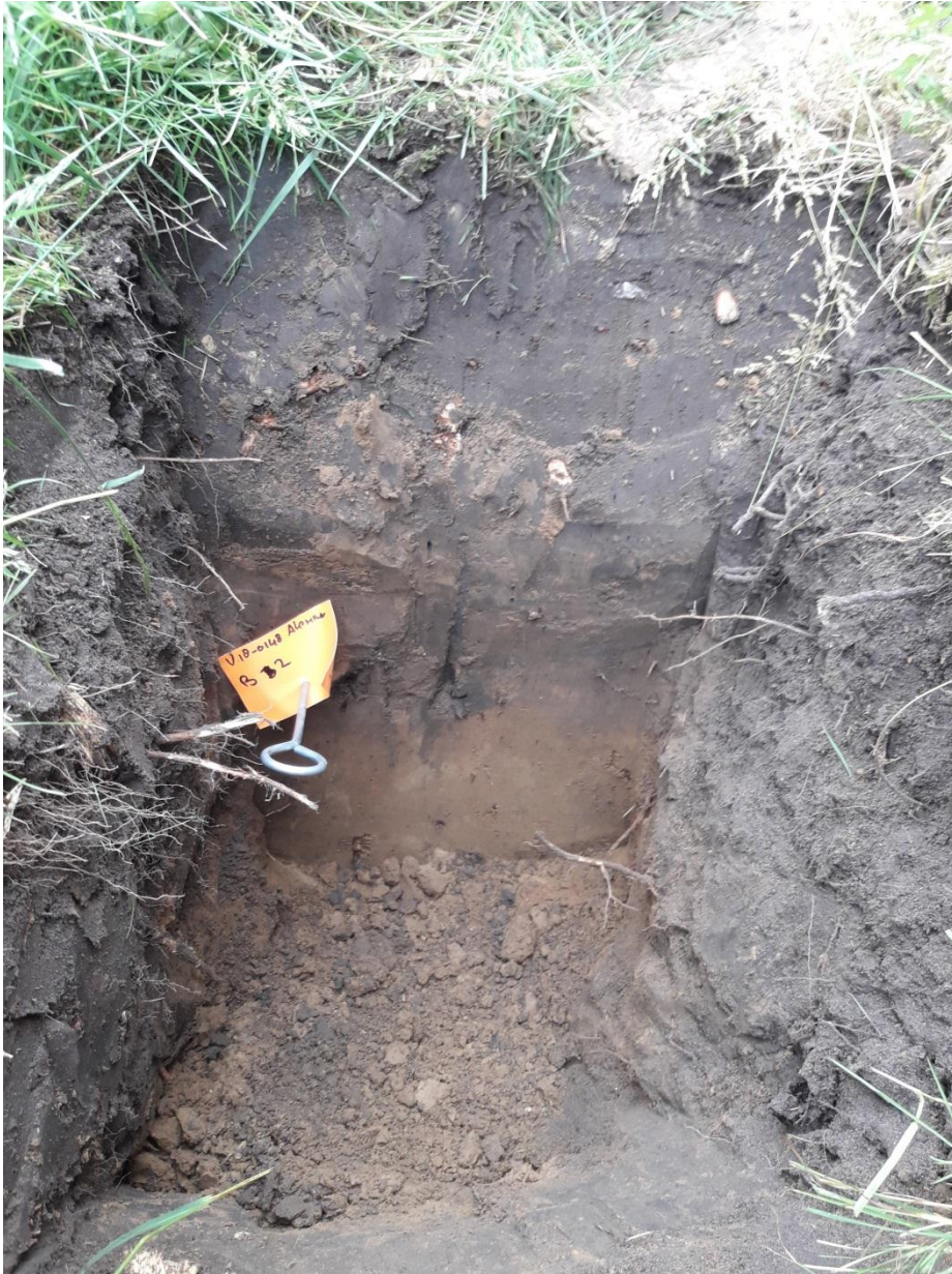
Figuur 3.2 Bodemopbouw ter plaatse van boring 2. Te zien is een doorwortelde bruingrijze Aa-horizont (plaggendek) die op ongeveer 0,5 m -mv geleidelijk overgaat in sterk siltig dekzand.
