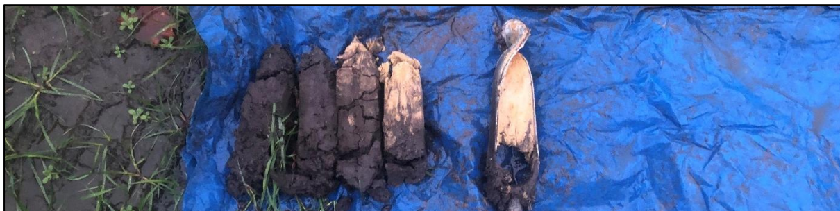
Boring 1: 0-60 cm -Mv. Dieper gelegen zand loopt uit boor onder invloed van grondwater.
