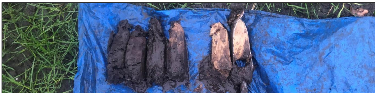
Boring 4: 0-70 cm -Mv. Dieper gelegen zand loopt uit de boor onder invloed van grondwater.
