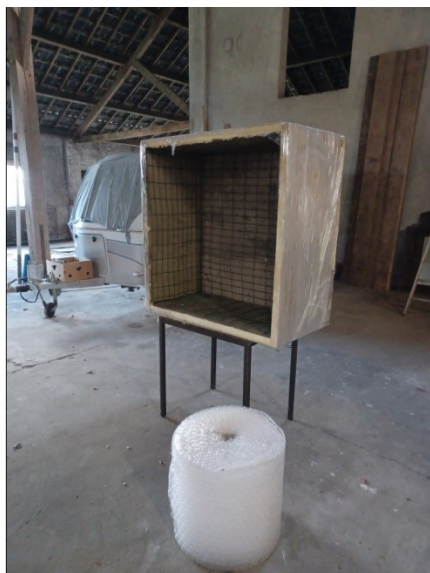
Figuur 6.3.1. Deze geluidswerende bekisting wordt rond de bestaande kerkuilennestkast geplaatst, zodat verstoring wordt voorkomen.
