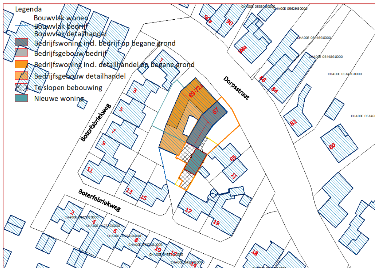
Figuur 3.2 Situatietekening verbouwplan en kadastrale situatie directe omgeving (bron: rekenmodel en opdrachtgever).
