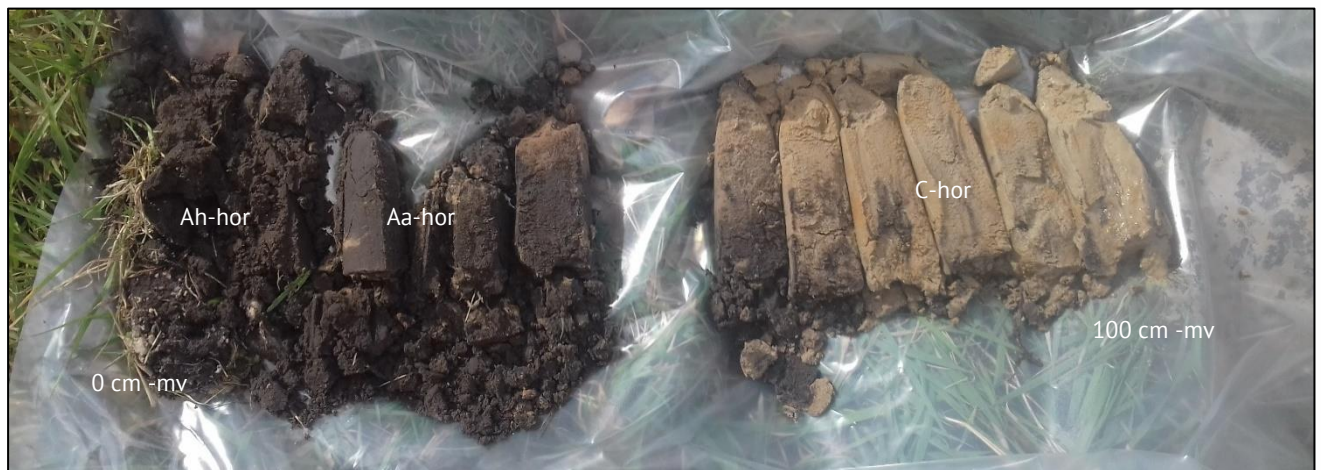
Figuur 6. Foto boorprofiel van boring 2. Leesrichting is van links naar rechts (0 – 100 centimeter).
