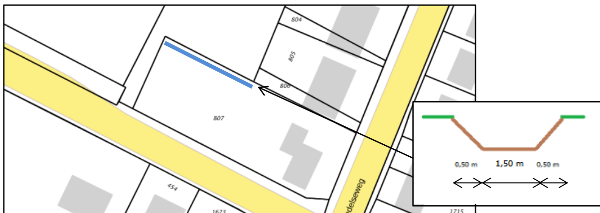
Afbeelding 12: Weergave situering en doorsnede infiltratiesloot
