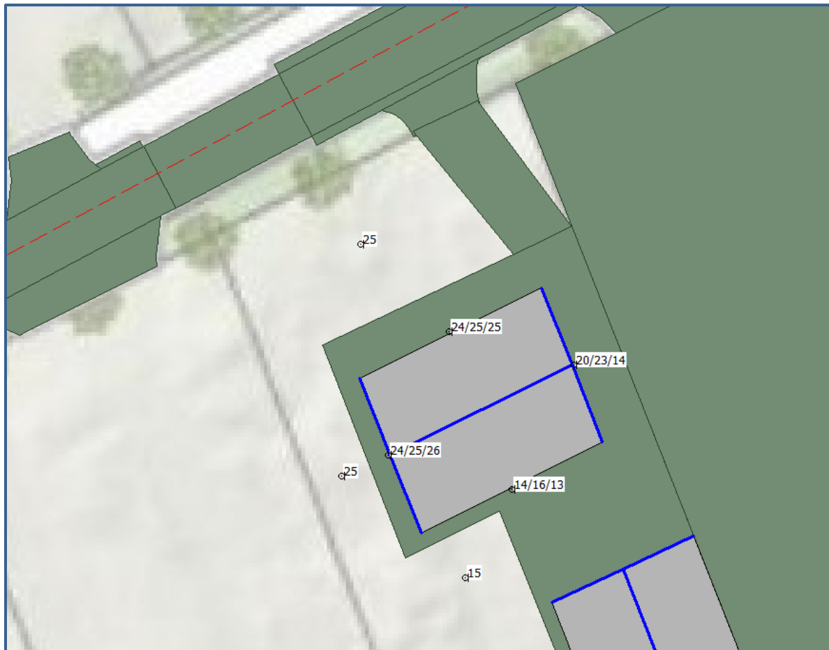
Afbeelding 5. Geluidbelastingen L_{den} (incl. aftrek art. 110g Wgh) Vensesteeg Berekende geluidbelastingen op een hoogte van 1,5 / 4,5 / 7,5 meter
