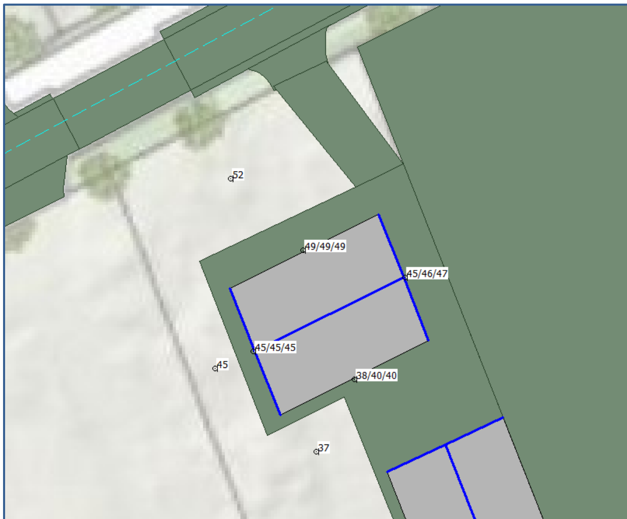
Afbeelding 8. Geluidbelastingen Lden (excl. aftrek art. 110g Wgh) cumulatief Berekende geluidbelastingen op een hoogte van 1,5 / 4,5 / 7,5 meter
