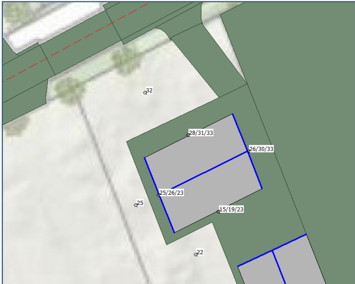
Afbeelding 6. Geluidbelastingen L_{den} (incl. aftrek art. 110g Wgh) Heescheweg Berekende geluidbelastingen op een hoogte van 1,5 / 4,5 / 7,5 meter
