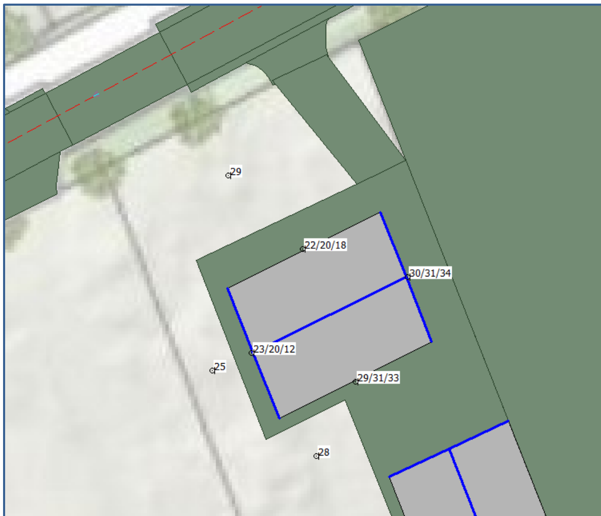
Afbeelding 7. Geluidbelastingen L_{den} (incl. aftrek art. 110g Wgh) Weijen Berekende geluidbelastingen op een hoogte van 1,5 / 4,5 / 7,5 meter
