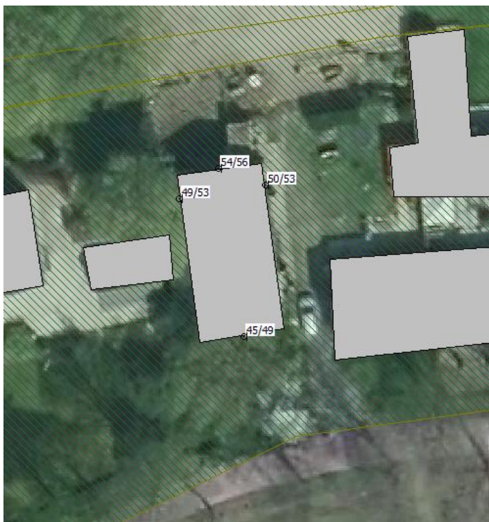
Figuur 4: Geluidbelasting ten gevolge van wegverkeerslawaaai op de A59 excl. aftrek volgens art. 110g Wgh
