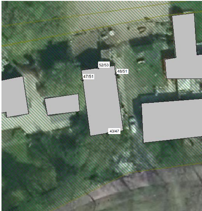
Figuur 3: Geluidbelasting ten gevolge van wegverkeerslawaai op de A59 incl. aftrek volgens art. 110g Wgh
