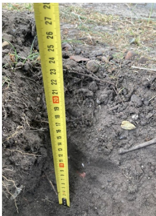
Beeld van de profielkuil met verdichte kiezel/splitlaag
