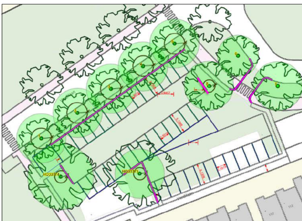
Afbeelding 9: Minimale graafafstanden m.b.t. de stabiliteit bij bomen met rondom vrij doorwortelbare ruimte (Handboek Bomen 2022, Norminstituut Bomen)
