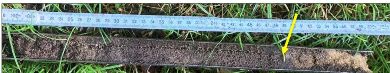
Afbeelding 6: Pijl: grens bruine grond en ondergrond (geel zand)
