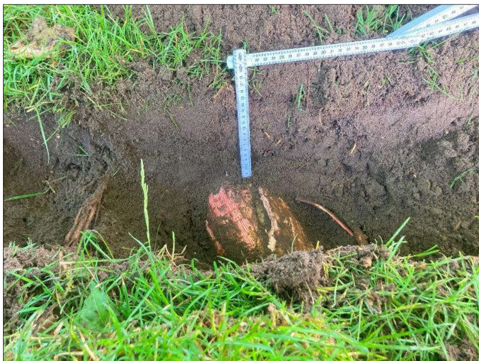
Afbeelding 16: Op 15 cm-mv is een wortel aanwezig (diameter 13 cm)
