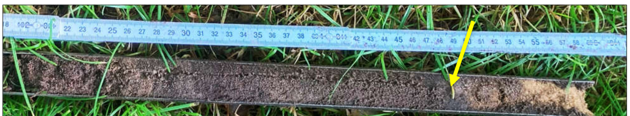
Afbeelding 6: Pijl: grens bruine grond en ondergrond (geel zand)
