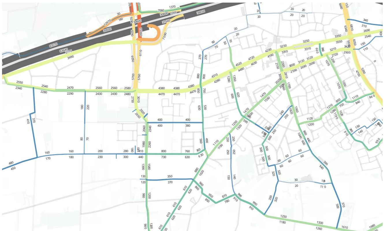
Figuur 3. Toekomstige intensiteiten verkeersmodel (motorvoertuigen per etmaal (mvt/etmaal), werkdagintensiteiten).
