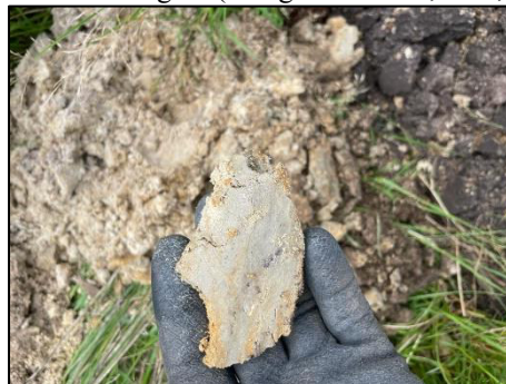
foto 6: boring 03 (kleiig zand van 1,0 – 1,3 m-mv)
