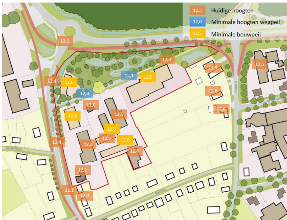
Afbeelding 22 Voorstel bouwpeilen en wegpeilen
