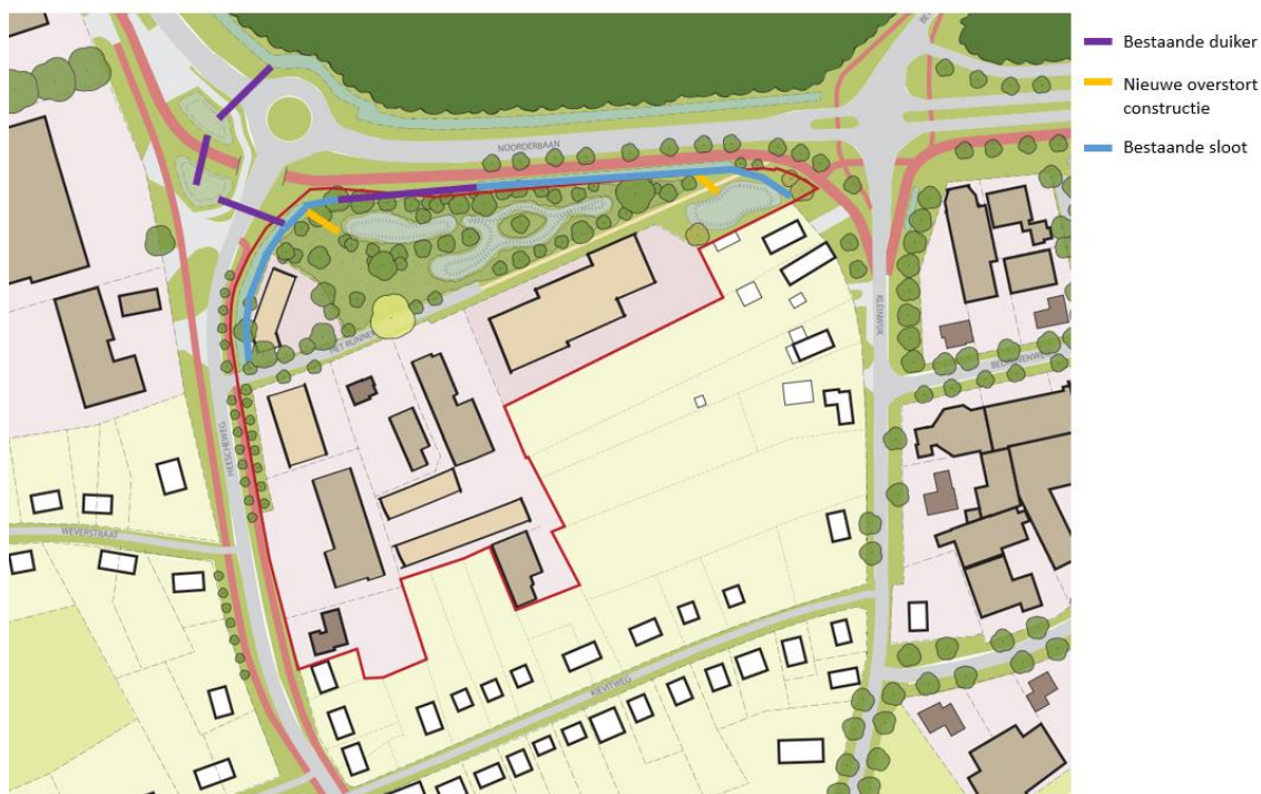
Afbeelding 21 Overzicht bestaande duikers en voorstel nieuwe overstortlocaties
