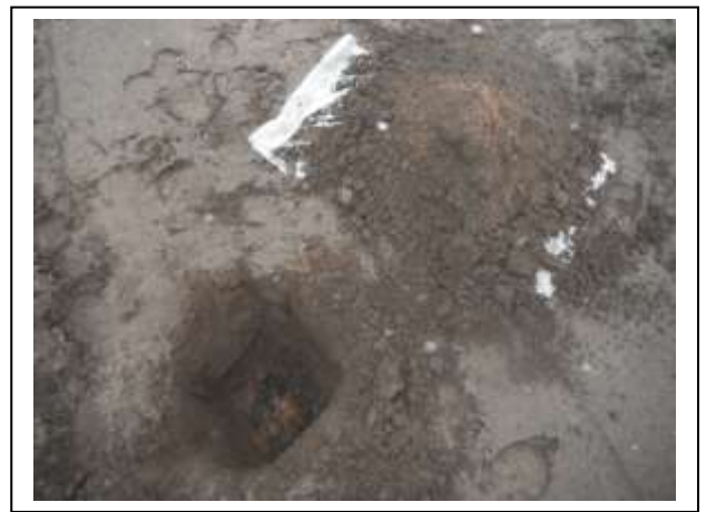
Foto 10. Asbestinspectiegat 10 met opgegraven materiaal
