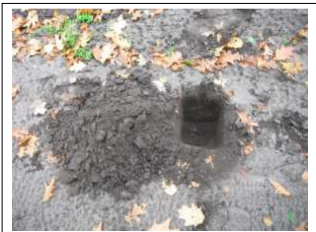
Foto 3. Asbestinspectiegat 03 met opgegraven materiaal
