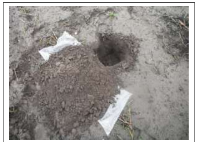
Foto 12. Asbestinspectiegat 12 met opgegraven materiaal
