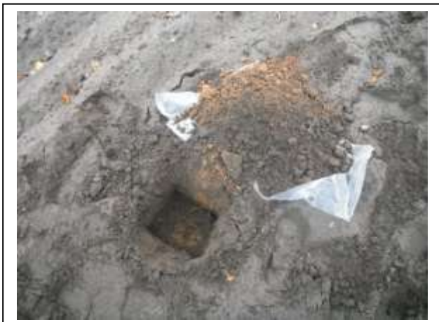
Foto 1. Asbestinspectiegat 01 met opgegraven materiaal
