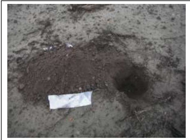
Foto 7. Asbestinspectiegat 07 met opgegraven materiaal
