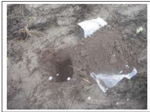
Foto 2. Asbestinspectiegat 02 met opgegraven materiaal
