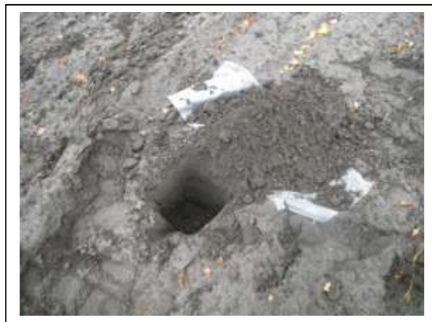
Foto 4. Asbestinspectiegat 04 met opgegraven materiaal
