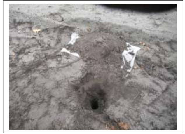
Foto 8. Asbestinspectiegat 08 met opgegraven materiaal
