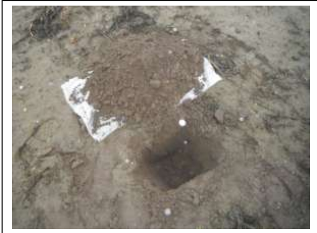
Foto 13. Asbestinspectiegat 13 met opgegraven materiaal
