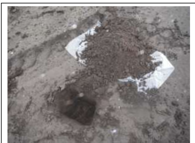
Foto 5. Asbestinspectiegat 05 met opgegraven materiaal
