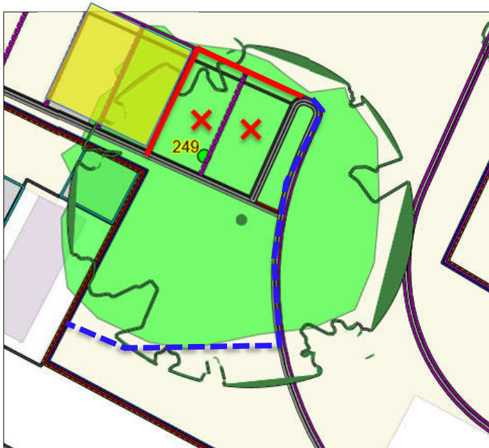
Afbeelding 19: Twee te vervallen parkeerplaatsen (rood kruis) bij minimale graafafstand van 2,5 m. Geel vlak: max. ontgravingsdiepte 30 cm en toepassing Permavoid. Blauw: locatie bouwhekken boombescherming
