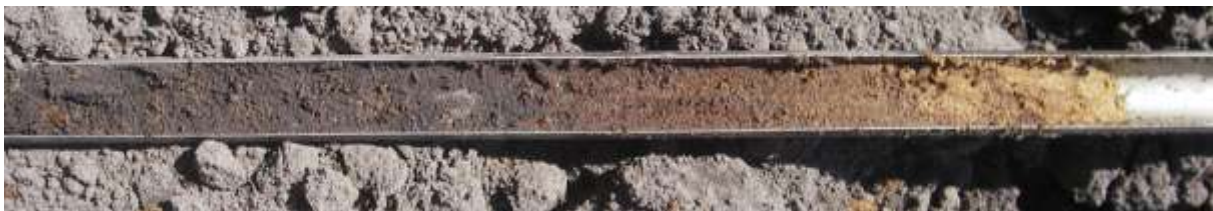
Figuur 21: Foto van het geoxideerde zand zoals dat in de boringen 5 en 9 onder de geroerde bovengrond is aangetroffen.
