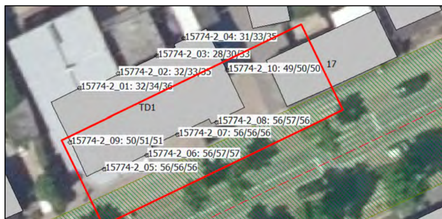
Figuur: Belasting gevel overschrijding voorkeursgrenswaarde
