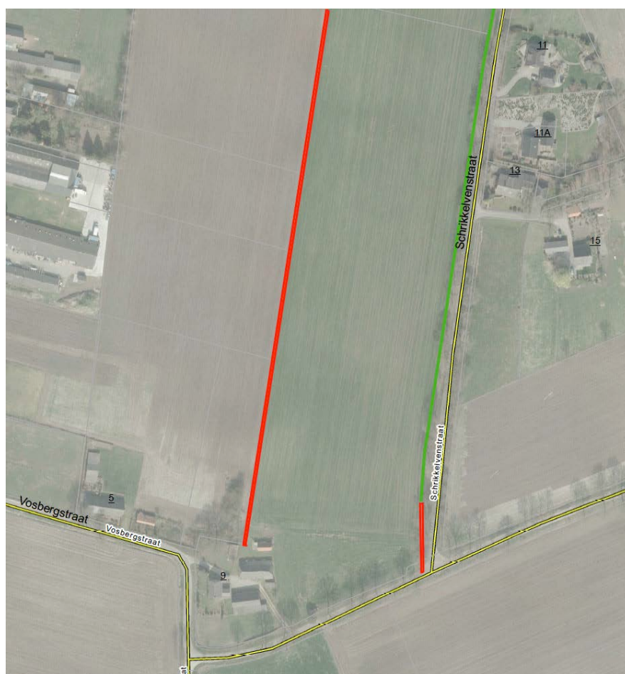
locatie bestaande sloten (rood = zaksloot / groen = schouwsloot)
