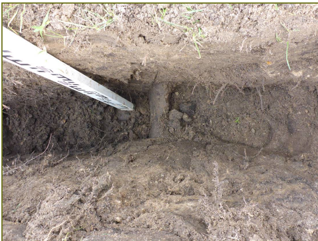
Afbeelding 5. Profielkuil 1 nauwelijks wortels en gemend zand aan de straatzijde
