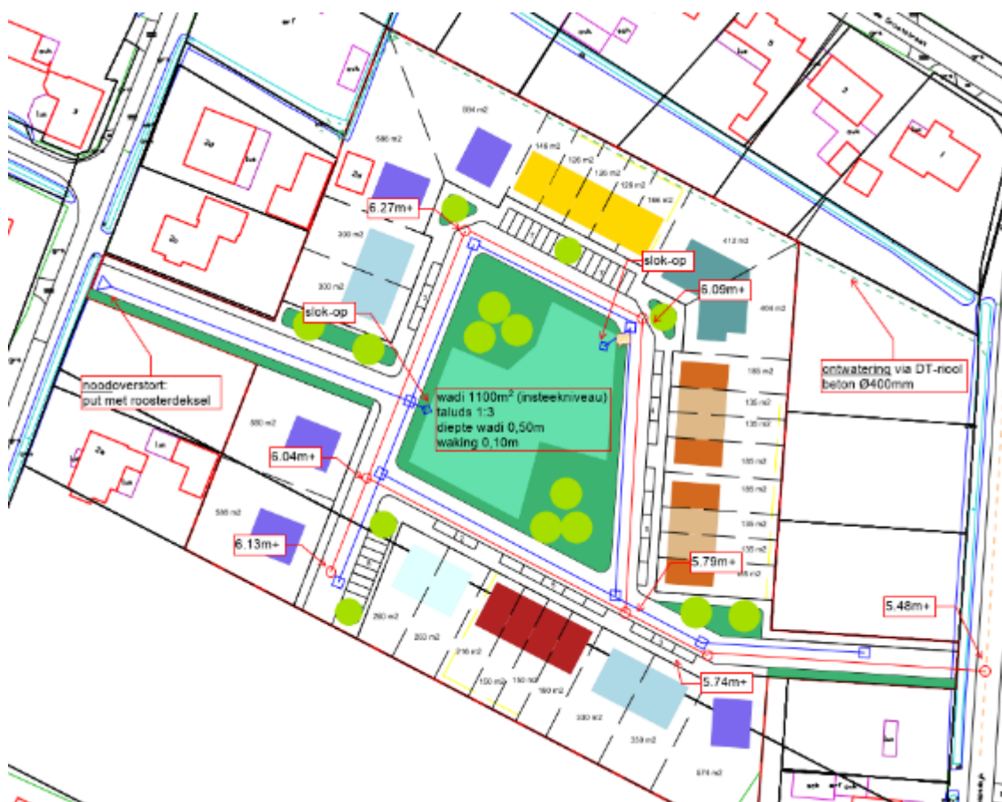
Figuur 4.8: stelselopzet met b.o.b. hoogten voor het dwa-stelsel
