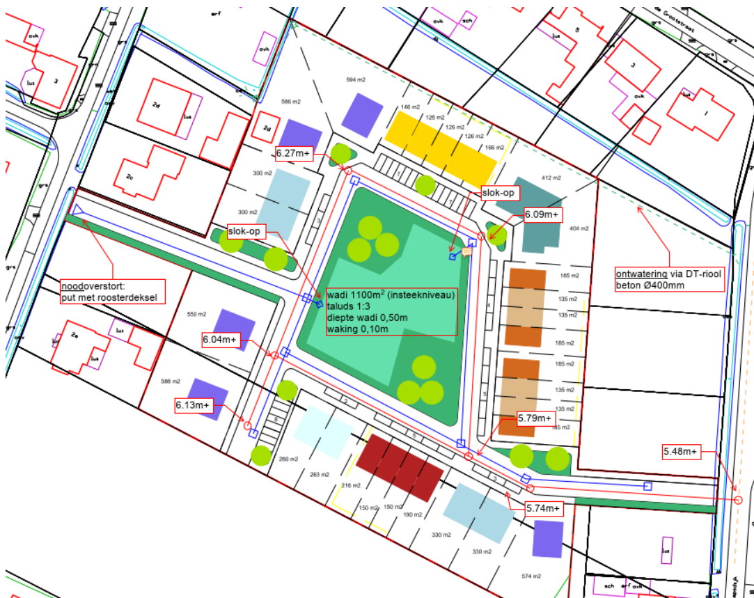
Figuur 7: stelselopzet met b.o.b. hoogten voor het dwa-stelsel
