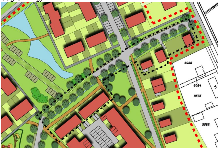
Figuur: woningen met rwa-afvoer rechtstreeks op wadi/watergang
