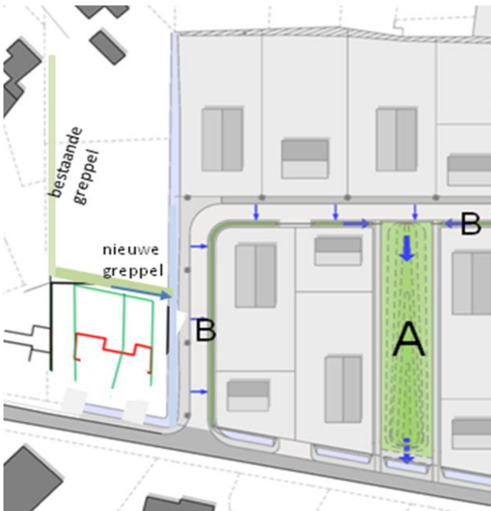
Afbeelding 8: watersysteem plan Peelstraat in relatie tot plan Ruimte voor Ruimte
