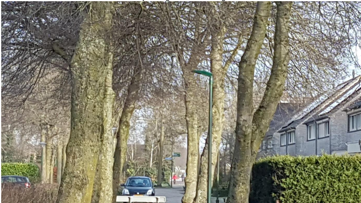
Foto 11: in het lindelaantje is reeds een led straatverlichting geplaatst die naar beneden is gericht. Hierdoor wordt lichtverstoring voorkomen bij vleermuizen die deze laan kunnen gebruiken als migratie route.
