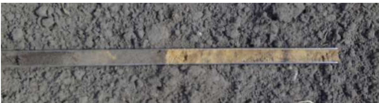
Figuur 19: Foto van de menglaag zoals deze op de boorpunten 6, 10 en 13 is aangetroffen (in dit geval op boorpunt 13).
