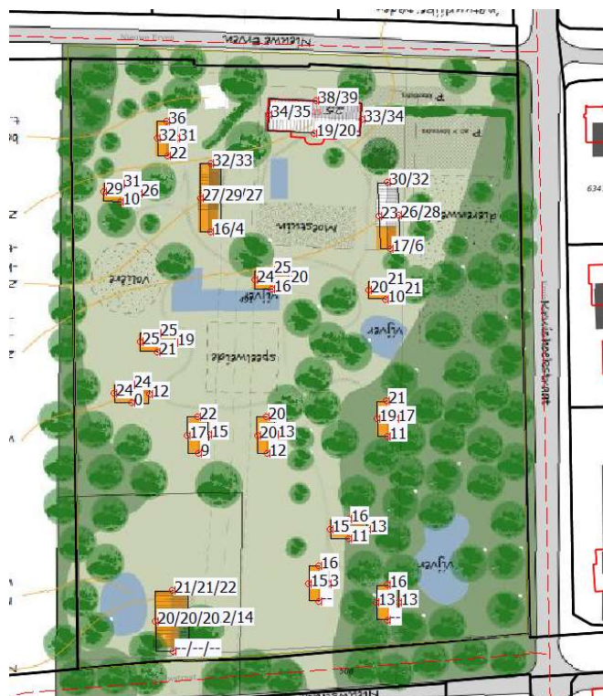
Figuur 4: Geluidbelasting ten gevolge van wegverkeerslawaai op de Nieuwe Erven incl. aftrek volgens art. 110g Wgh
