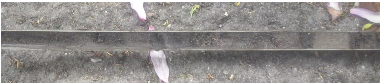
Figuur 17: Foto van boring 7 met de gelaagde beekafzetting die vanaf ongeveer anderhalve meter beneden het maaiveld is aangetroffen.
