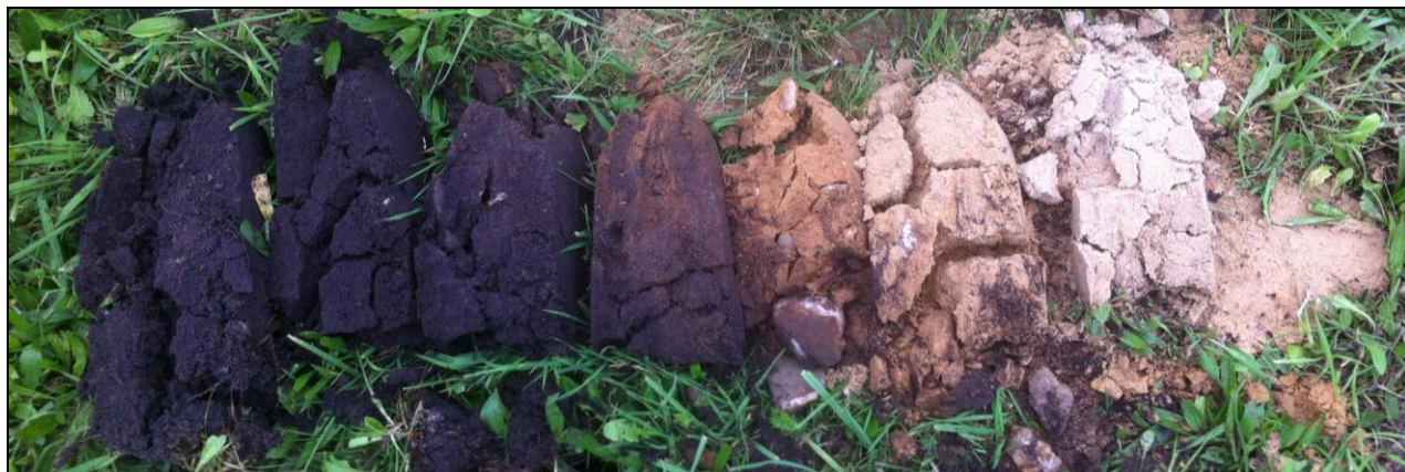
Figuur 4: boorprofiel van boring 6 met daarin een B-C overgang.
