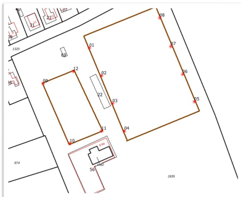
Figuur 3: Positie van de 12 lichtmasten met armaturen
