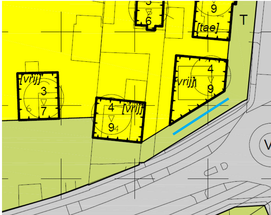
Figuur 1: Schematische weergave waterberging Broekhoek 1
