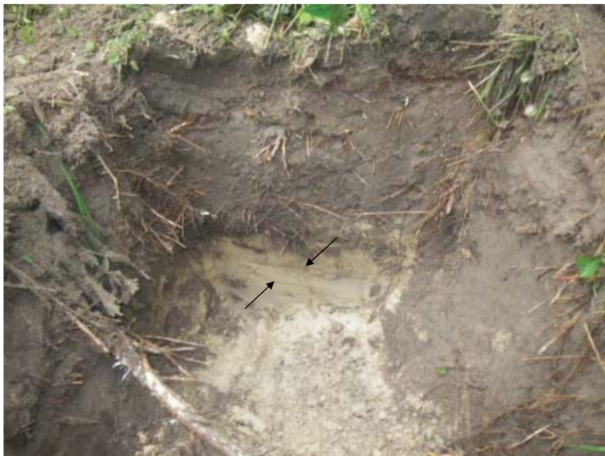
Figuur 5: Het kijkgat. De overgang van de humeuze toplaag naar het schone zand is scherp. In het zand zijn haarlijnen zichtbaar bij de zwarte pijlen. De humeuze laag is ca. 30 cm .dik.
