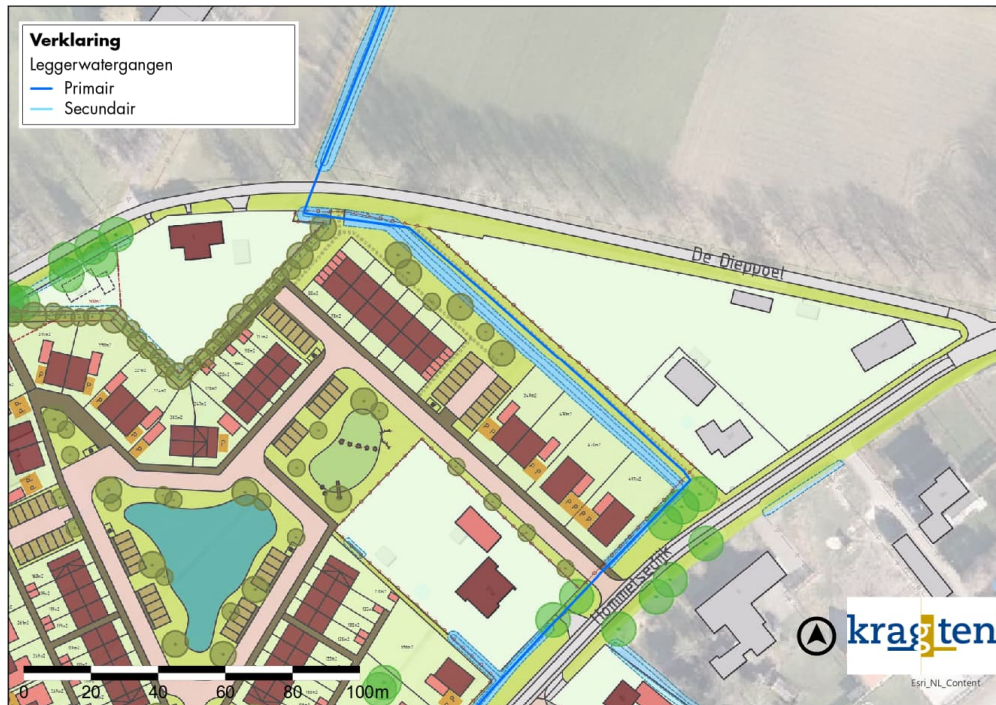
Afbeelding 21 A-watergang in het nieuwe ontwerp wordt verlegd ten opzichte van huidige situatie
