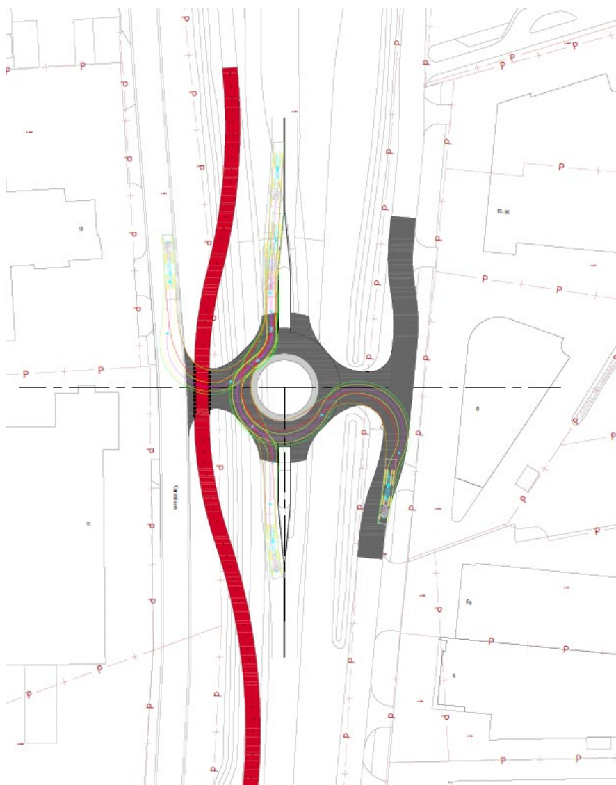
Figuur 2.2: Ontwerp enkelstrooksrotonde Cereslaan (ontvangen van opdrachtgever op 22-8-2023).
