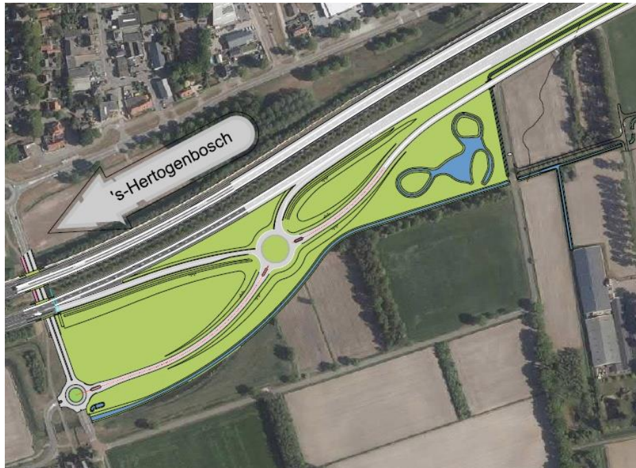
Geoptimaliseerd ontwerp aanpassing afrit Nuland en aansluiting Bosschebaan/Rekken
