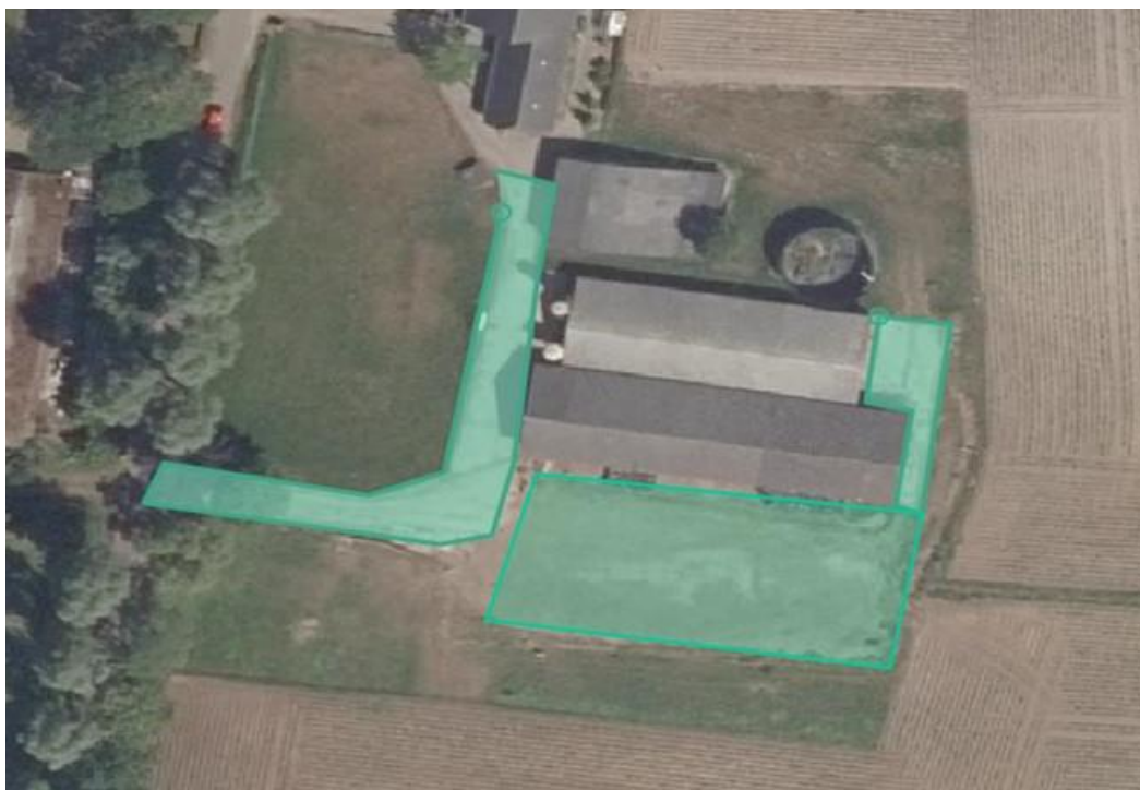
Figuur 14 te verwijderen verharding
