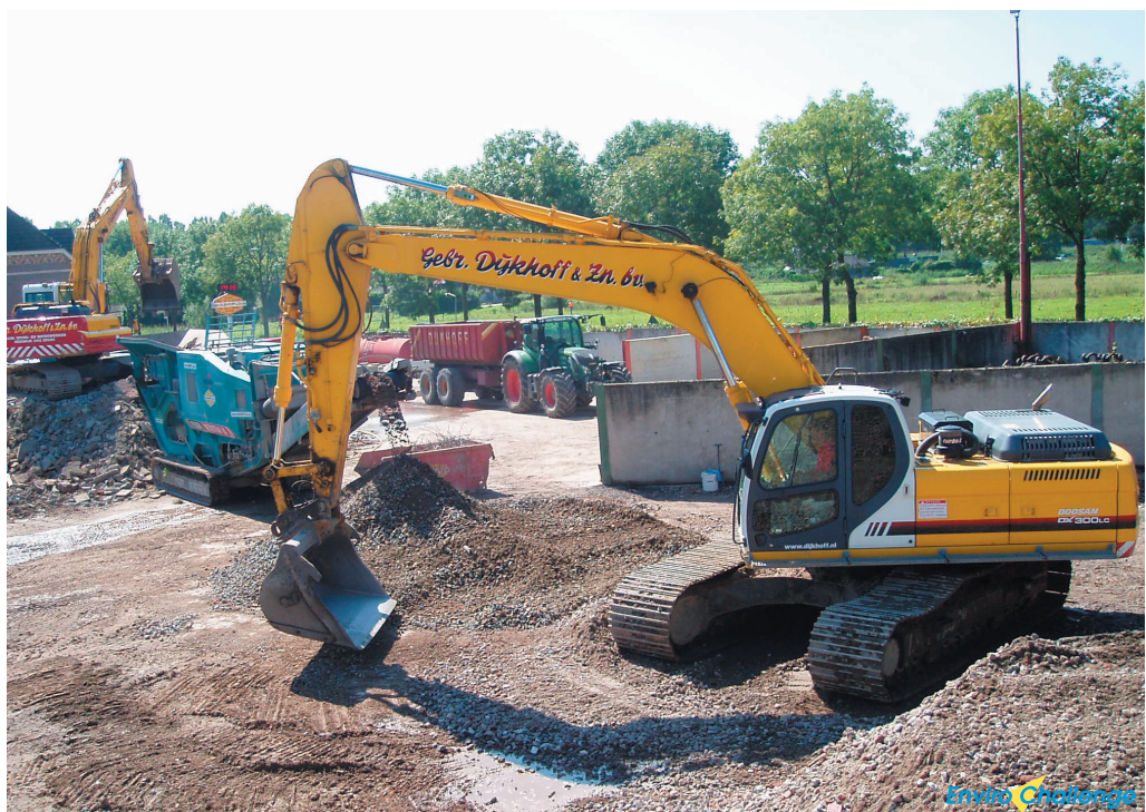
Illustratie 6 : Granuleren van puin met beheersmaatregelen (bevochtiging van invoer en afvoerband)
