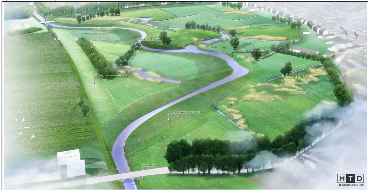
Figuur 3.2: Ontwerp stroomafwaartse deel van het beekdal Aa waarbij de Aa weer meer mag meanderen.
